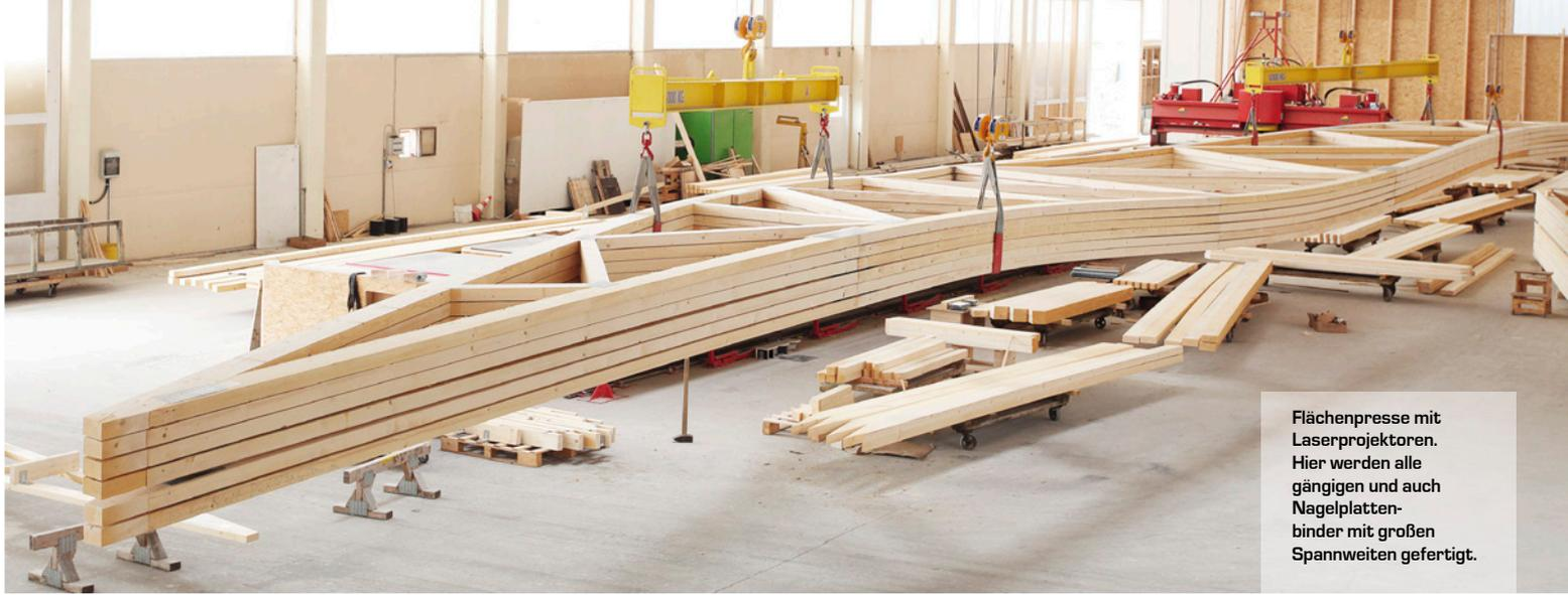
Flächenpresse mit Laserprojektoren. Hier werden alle gängigen und auch Nagelplattenbinder mit großen Spannweiten gefertigt.
